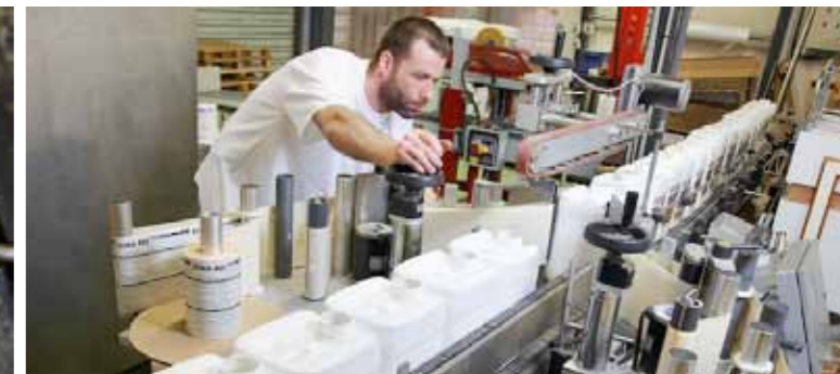
■ Po napełnieniu na opakowania nakleja się etykiety. Następnie jest przeprowadzana kontrola jakości – sprawdza się m.in. szczelność zbiorników.
