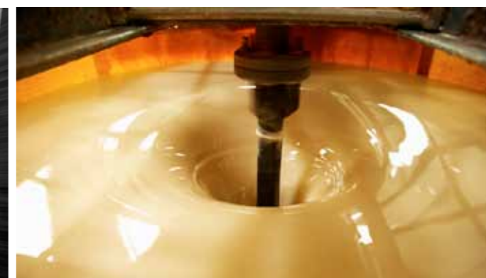
■ Składniki nawozu są mieszane z dużą prędkością do momentu uzyskania jednorodnej i stabilnej substancji.
